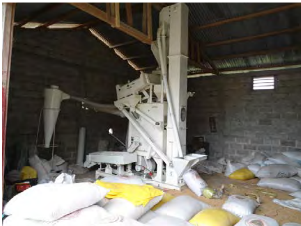
Salty Trading の所有する精米機 (インドネシア、スラバヤのある農業機械メー カーの精米機である。日当り 15 t の精米能力を もつ。)
