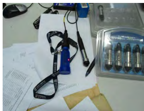
同圧力センサー、データロガー (中央)
