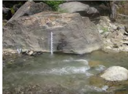
Comoro 川量水標 (圧力センサーはポリエチレン管内に挿入し、に量水標に固定する例が多い。)
