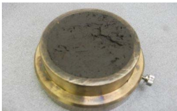
写真2-24. 不飽和状態のブラックコットンソイル 写真2-25. 飽和状態のブラックコットンソイル
