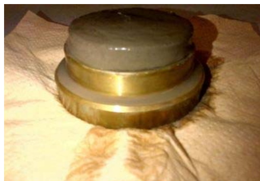
写真2-24. 不飽和状態のブラックコットンソイル 写真2-25. 飽和状態のブラックコットンソイル
