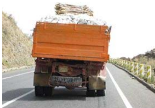
写真2-5. 勾配が10%程度あり碎石を満載しているために速度は10km/h以下である。右側タイヤの通過線上にアスファルトの染み出しが見られる。
