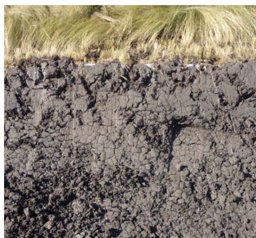
写真2-15. 乾燥状態のブラックコットンソイル（CBR調査等では高強度を示す場合がある）
