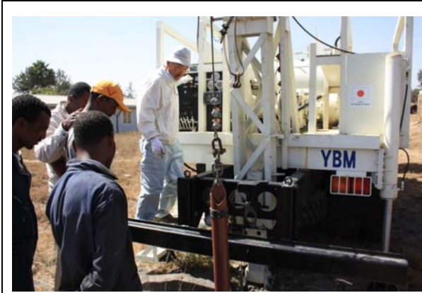
サービスリグを用いた井戸リハビリ実習を指導する日本人専門家(掘削技術)。
