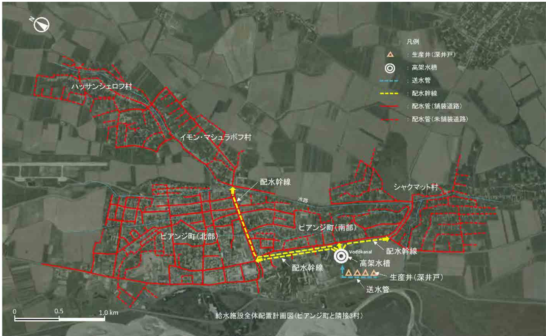
図3-2-1 給水施設全体配置計画 (ピアンジ町と隣接3村)
