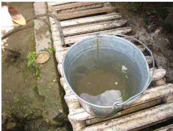
写真3：浅井戸の水 濁っているだけではなく、水質試験の結果、大腸菌等で汚染されていることが明らかになった。
