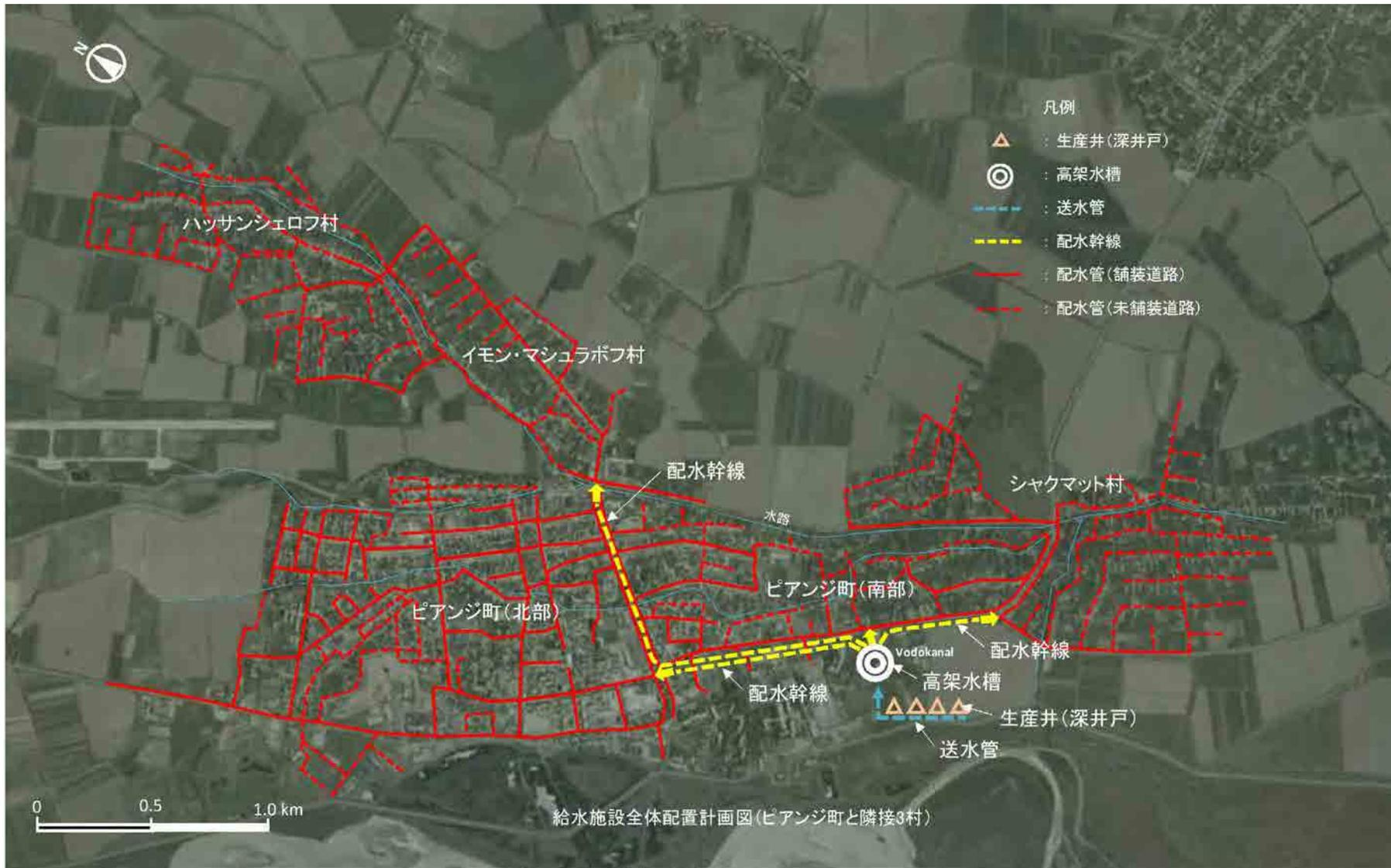
図3-2-1 給水施設全体配置計画 (ピアンジ町と隣接3村)
