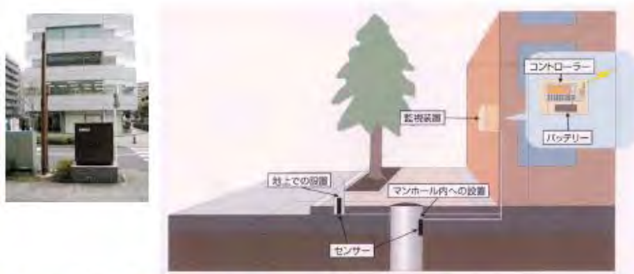
図 3-42 浸水センサー設置状況
