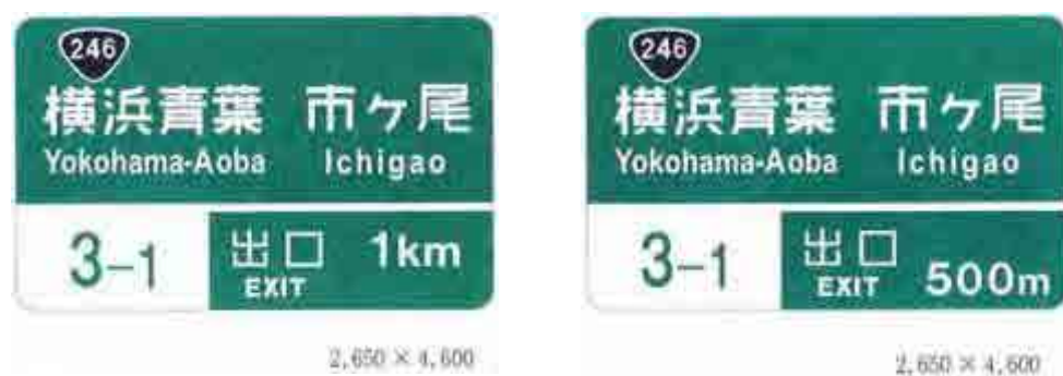
図 11.19: 出口案内標識 (110-A 型標識)
