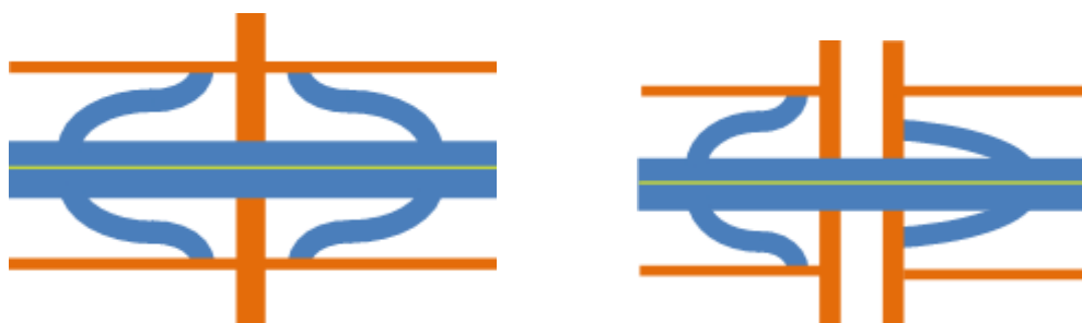
C3: ダイヤモンド型+平面交差点 (サービスロード) C4: ハーフインターチェンジ型 (ハーフダイヤモンド)
