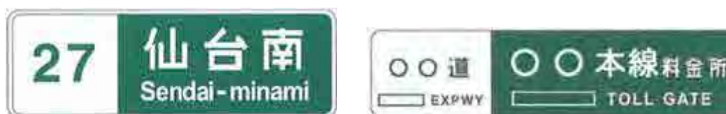
図 11.44: 料金所屋根上のインターチェンジと料金所プラザの標識
