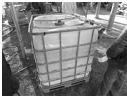
写真：1.0m 3 の輸送用タンク
