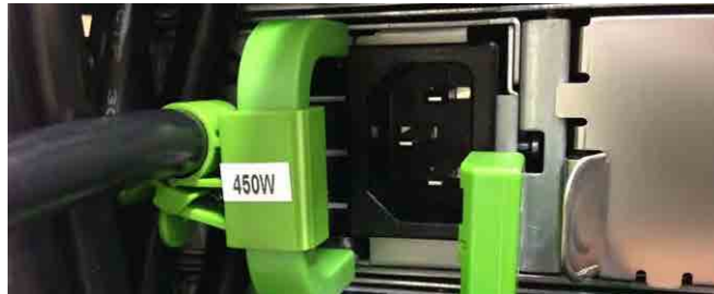
รูป 4-1-2-1 (2) ช่องเสียบสายไฟ ด้านหลังเซิร์ฟเวอร์
