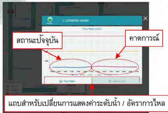
แสดงระดับน้ำและอัตราการไหลของน้ำ ณ จุดนั้น
