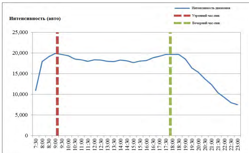
Рисунок 6.1-3 Объем трафика с 30-минутным интервалом
