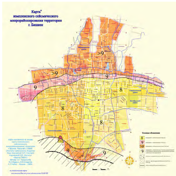
Рисунок 2.1-5 Карта-схема инженерно-геологических условий г. Бишкек
