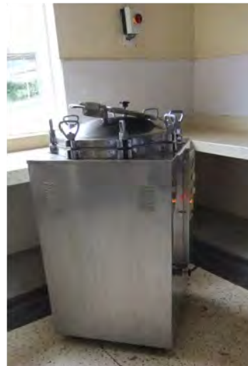
CSSD 滅菌器：現在も頻繁に使用されているが、旧型のためスペアパーツの購入が難しくなっている。
