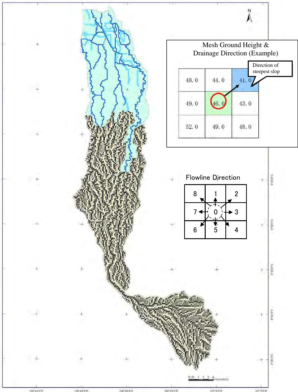
**Figure 3.2-12 Drainage Direction Map (Discharge Basin)**
