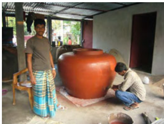
写真 9-8 色セメントによる仕上げ
