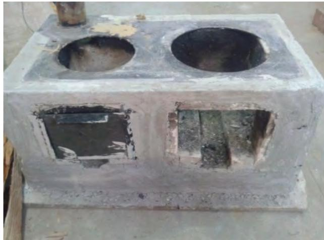
写真 5：落脱した焚口保護枠
