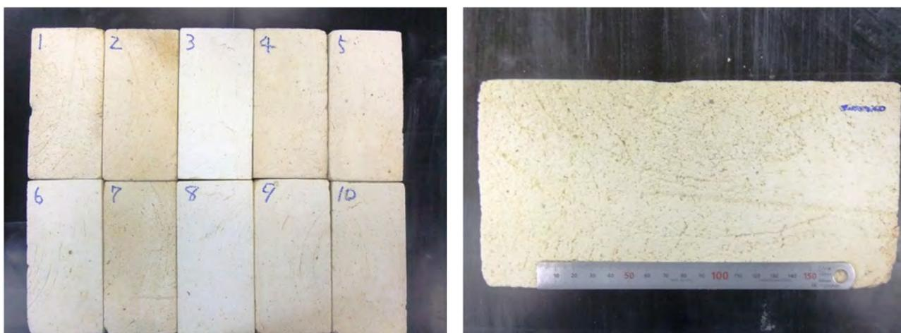
写真 4：インド製断熱レンガの外観写真
