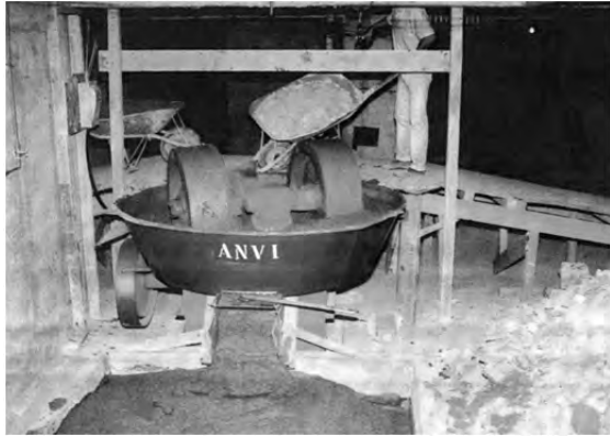
(3) Equipo “ANVI500” para reciclaje “in situ”, produciendo argamasas a partir de escombros generados en obras de construcción
