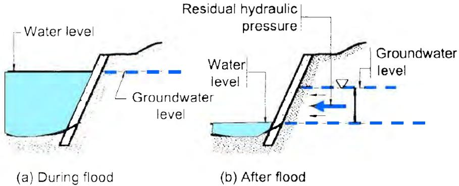
Dezenvolvimentu husi Pressaun Hidráulika Residual sein;laiha Pipa Drenajen/Ku'ak Berongga (Hydraulic Pressure without Drainage Pipes/ Weep Holes)
