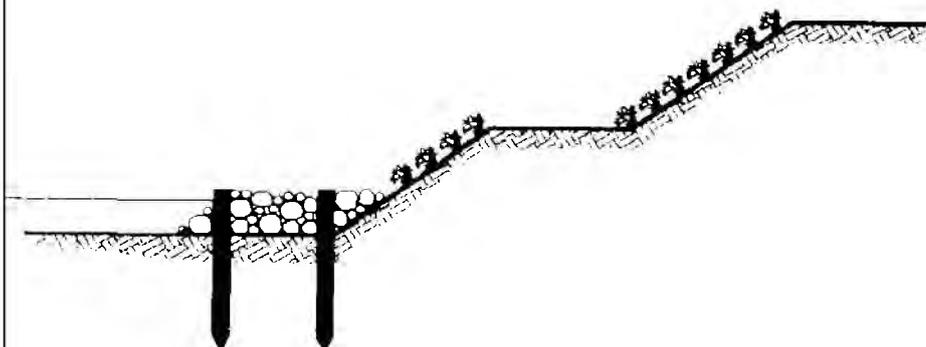
**Bele permite Velocidade Máxima < 2.0 m/s**
