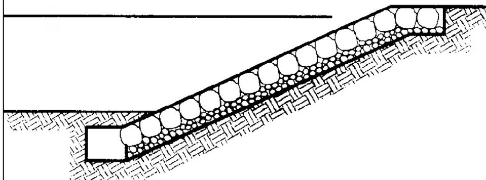
**Bele permite Velocidade Máxima > 5.0 m/s**
