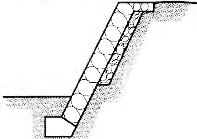
**Bele-permite Velocidade Máxima > 5.0 m/s**
