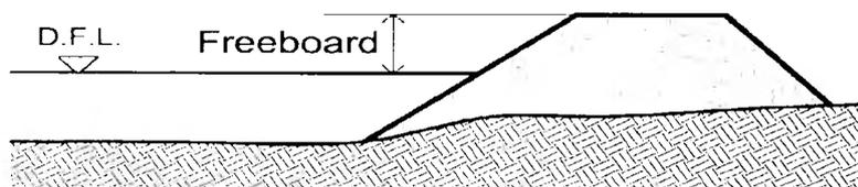
**Altura Dique = Dezeñu Nivel inundasaun ou Design flood level + Liña Livre ka Freeboard**
