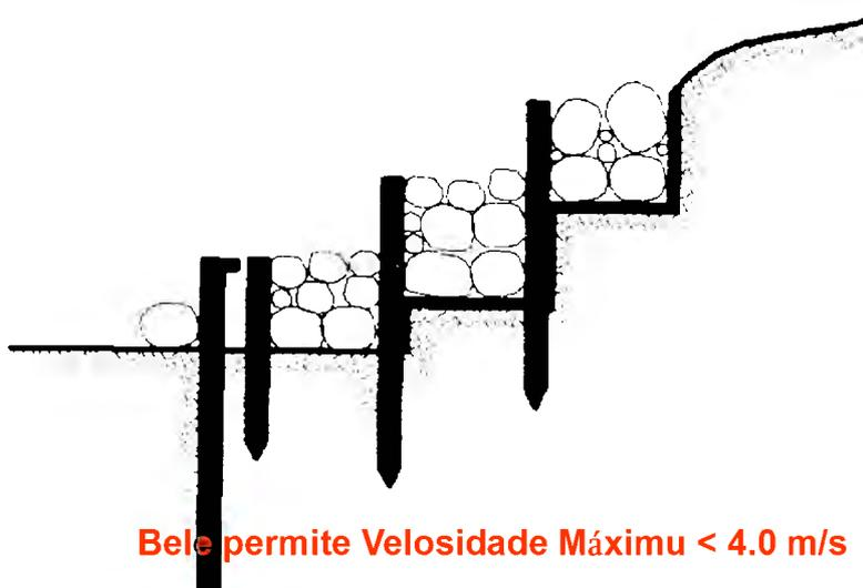
**Bele permite Velocidade Máxima < 4.0 m/s**
