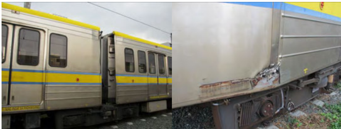
図 5.1-2 第二世代車両：車体が衝突事故により変形している (1107)
