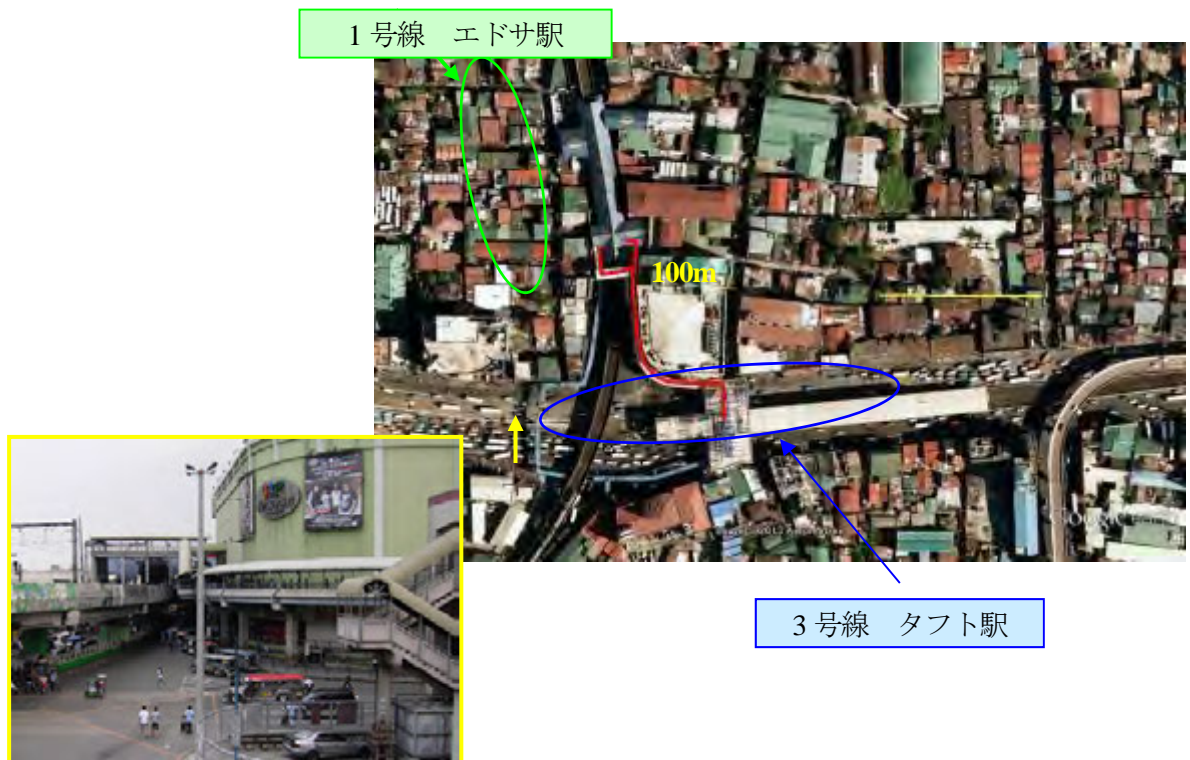
図 12.3-1 2号線と3号線との接続
