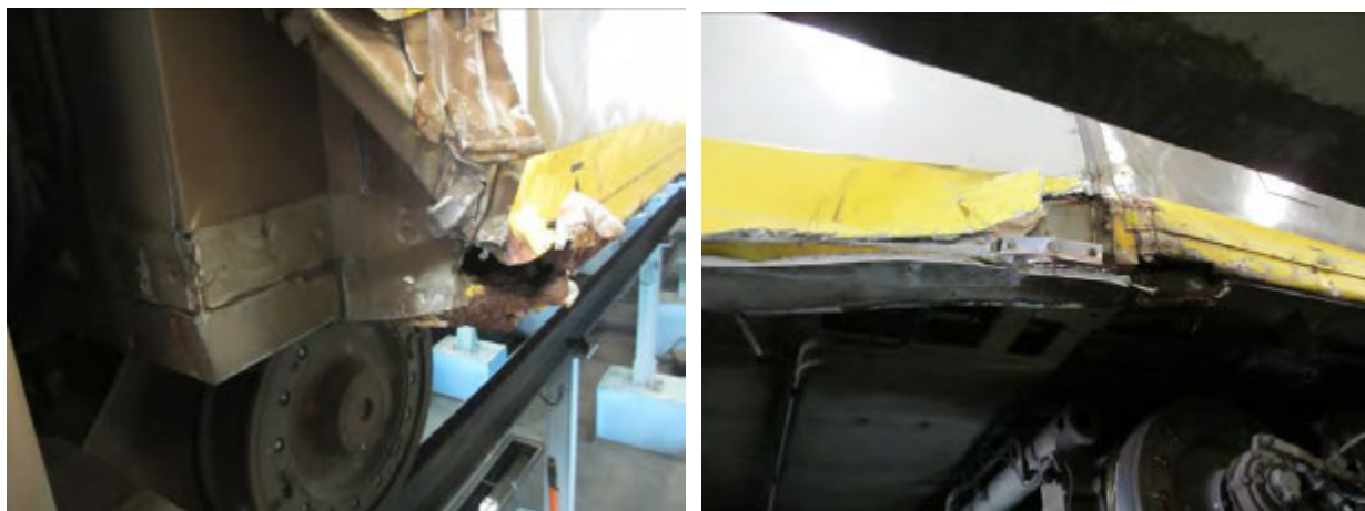
図 5.1-3 第三世代車両：車体外板が損傷しめくれている (1236)
