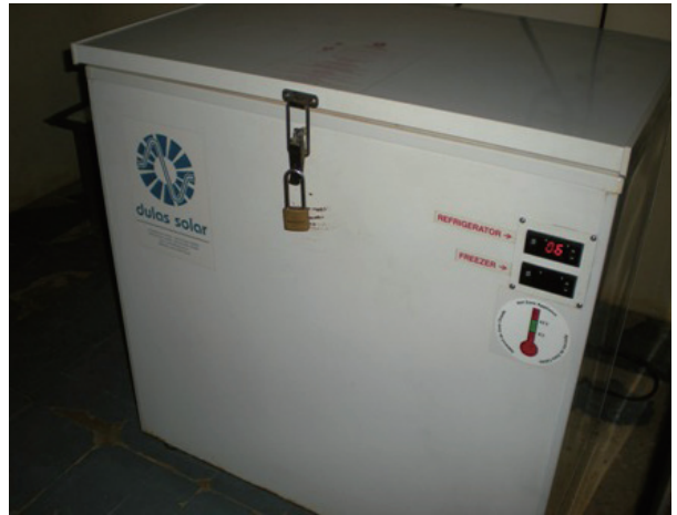
ワクチン保存用ソーラー式冷蔵庫 Bo Gerihun CHC (一次医療施設)
