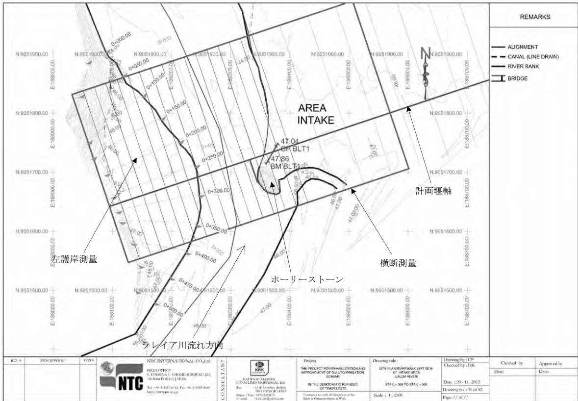
図 2 - 13 取水工予定地左岸測量 平面図
