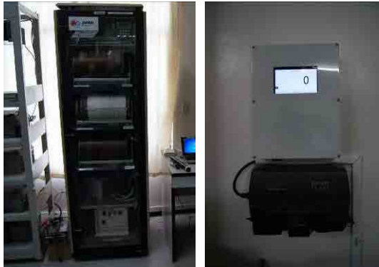
過去の無償で導入された地震観測システム (左) 震度表示システム (右)
