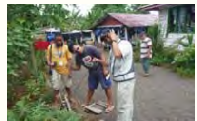
メーターでの漏水音聞き取り
