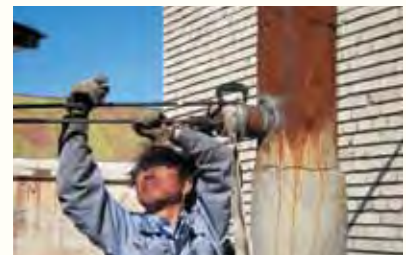
煙突中の排ガス濃度を測定している様子
