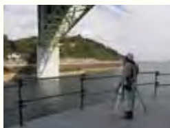
「KUMONOS」による橋梁の遠隔隔び割れ計測(関西工事測量(株))
