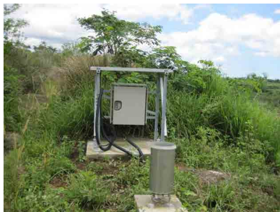
バ川沿いの自記式雨量計・水位計
