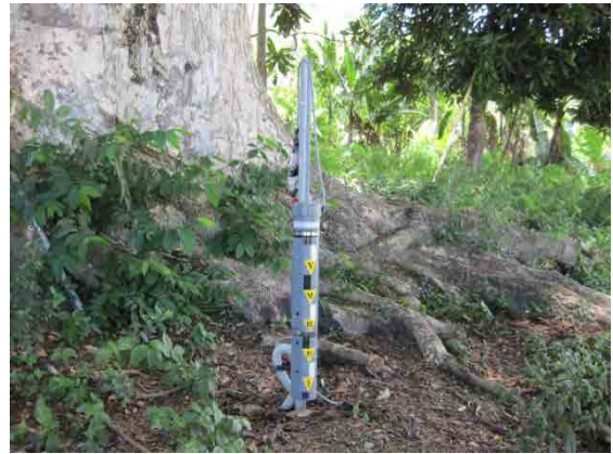
設置された簡易水位計
