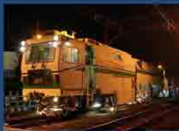
Выправка рельсового пути с использованием выправочно-подбивочно-рихтовочной машины (МТТ)
