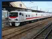
電気軌道総合検測車 (East-E)
