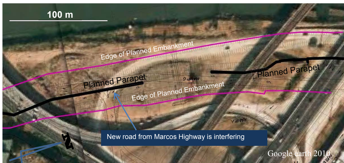
図 3.10 マルコスハイウェイ分岐合流点における道路との干渉
