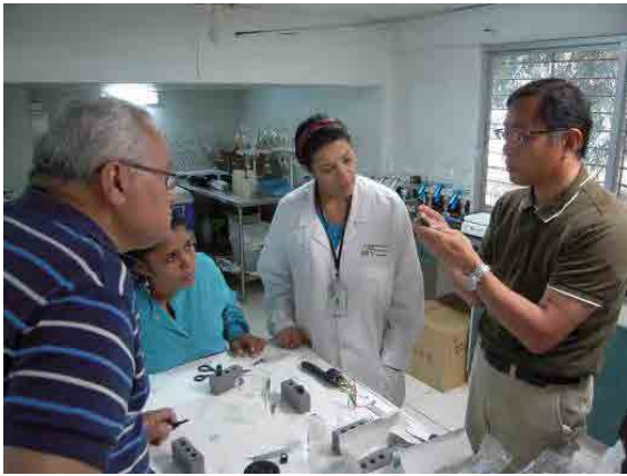
写真 7: マルチ水質モニタリングシステムの DO 膜交換に関する技術支援の様子。
