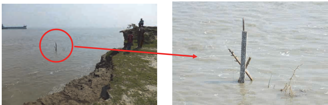
写真 4-1 BWDB 設置の水位計
