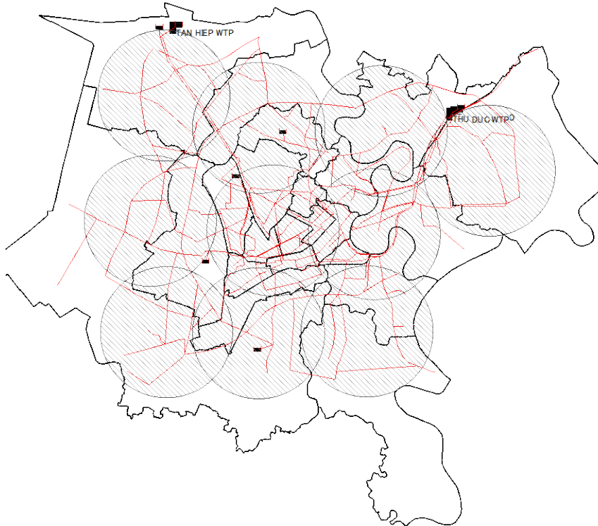
図 2-3-11 配水区域 10 分割:水圧平準化-半径 5km
