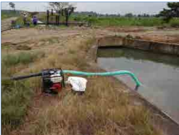
写真2-5 幹線水路からのポンプ取水
