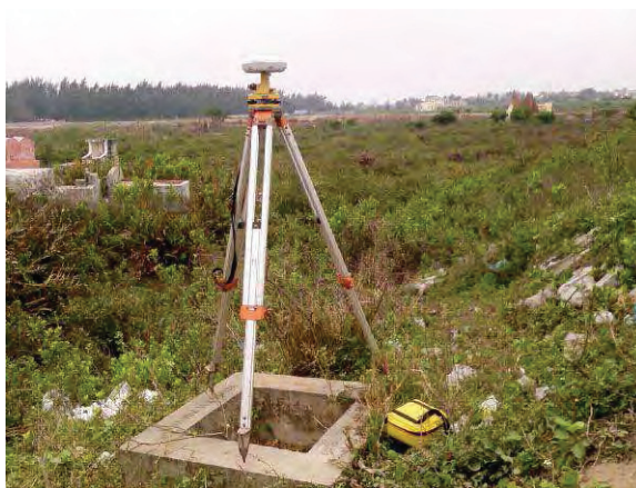
Ảnh chụp vị trí mốc khống chế nhà nước đặt máy thu GPS
