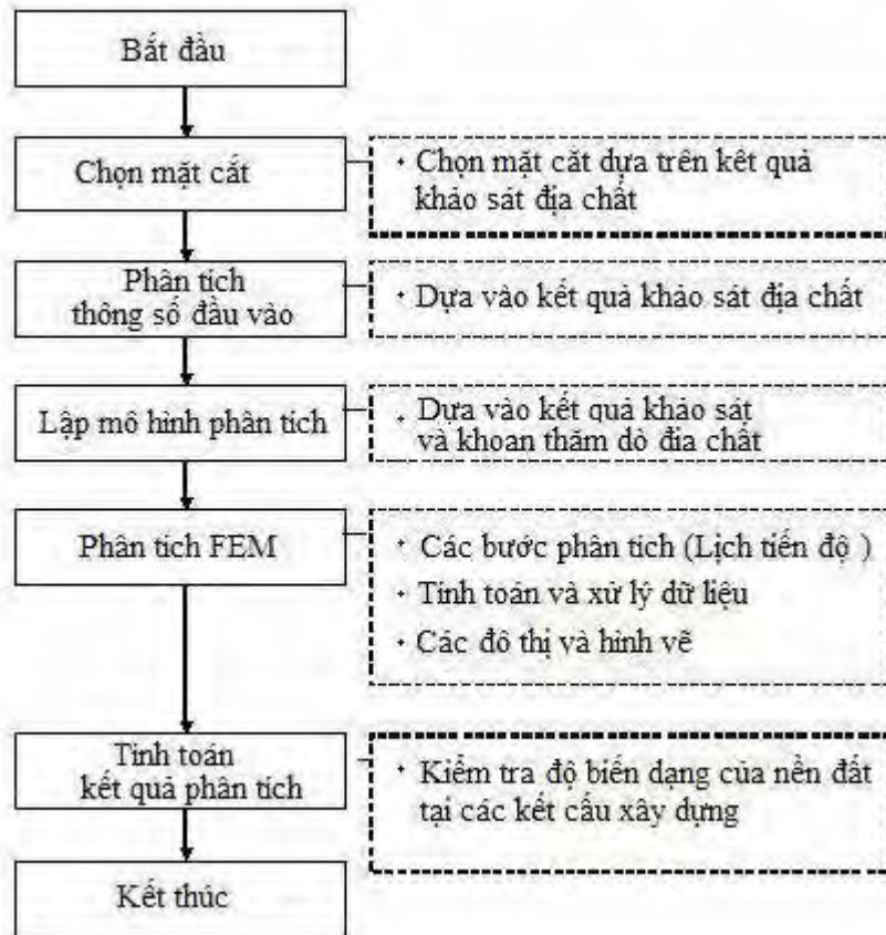
Hình 16.2.2 Quy trình phân tích biến dạng FEM
