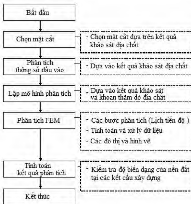
Hình 16.11 Quy trình phân tích biến dạng FEM
