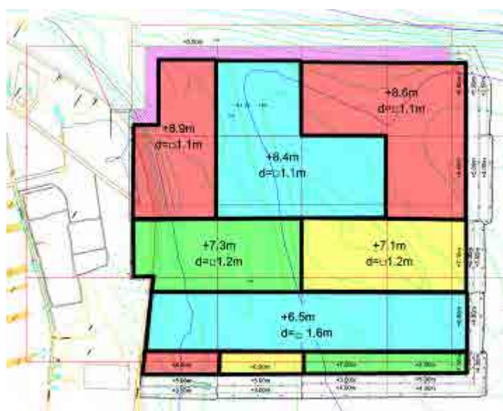
図 16.3 護岸部を含む埋立計画エリアにおけるプレロードの施工区分
