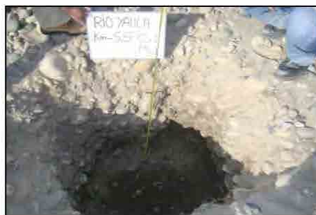
Llenado de agua a la calicata para determinar el volumen excavado
