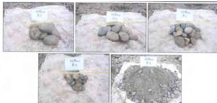
Materiales extraídos de la excavación de calicata
