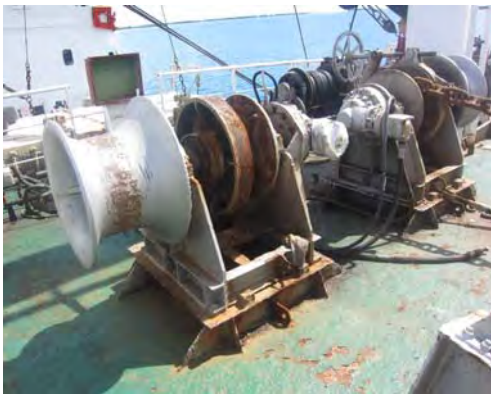
ウインドラス 右舷側アンカー喪失
