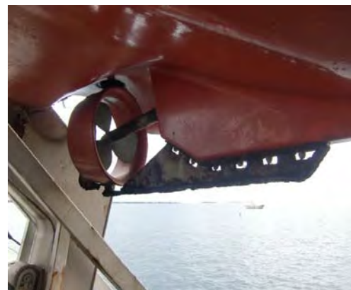
救命艇のスケグ金具が腐食
