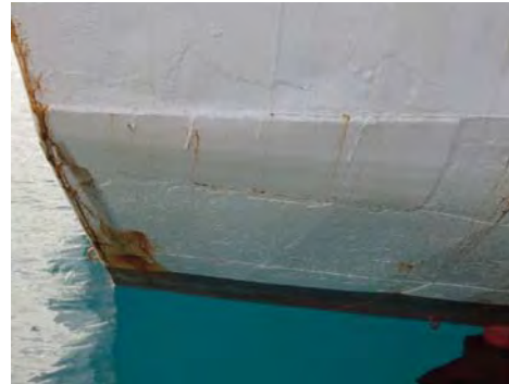
船尾 外板交換部と錆
