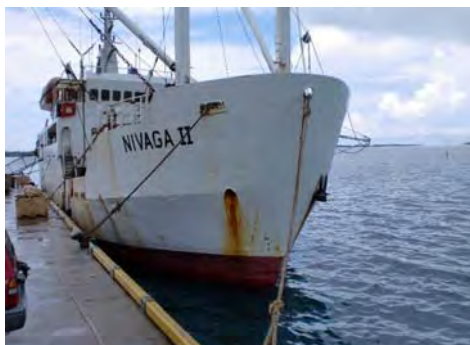
船首部ホースパイプからの錆
