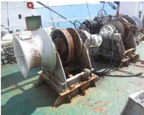
ウインドラス 右舷側アンカー喪失
