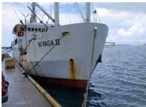
船首部ホースパイプからの錆
