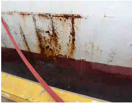
各所に外板の錆が顕著
