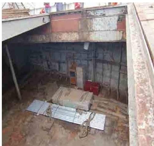
貨物艙 ハッチコーミング、ピラー、側壁鋼板の各所に錆が顕著
