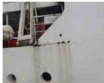
船首部外板の腐食孔
