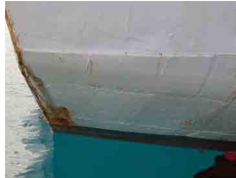
船尾 外板交換部と錆
