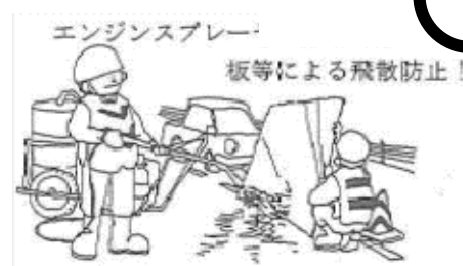
Dùng tấm gỗ ngăn vật liệu vung vãi
