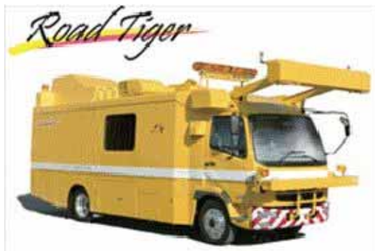
Xe đo bề mặt đường tốc độ cao Road Tiger Central Nippon Highway Engineering Tokyo Co., Ltd.
