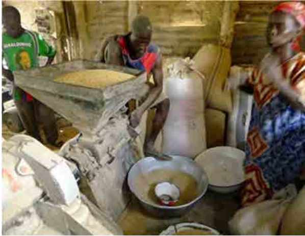
農村では一般的に利用されている、モーターで駆動するエンゲルバーグ式の精米機（安価である一方、比較的性能は低い）
