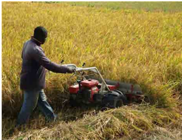
2009年度2KRで調達された刈り取り機（アフィフェ 灌漑スキームで利用されている。作業効果が確認 されており、ニーズも高い）
