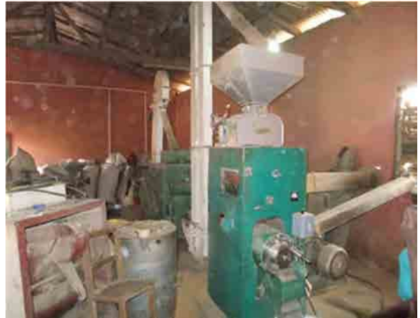
クマシ市の灌漑スキームで稲作を行う農民組織が 利用するワンパス式の精米機
