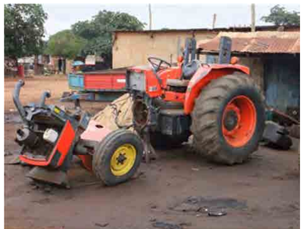
2007 年度 2KR で調達されたクボタのトラクター（エンジン部品が入手できないためにエンジンごと中古に交換している）
