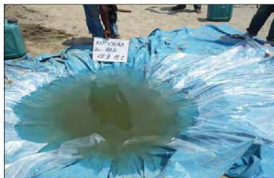
Llenado de agua a la calicata para determinar el volumen excavado
