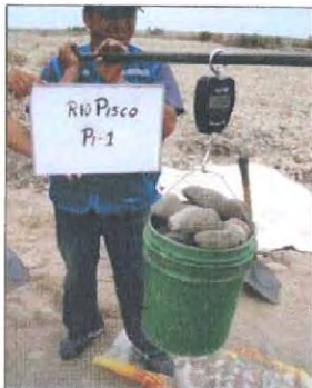
Determinación del peso por tamaños de los materiales extraídos de la calicata
