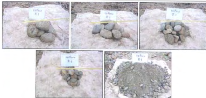
Materiales extraídos de la excavación de calicata
