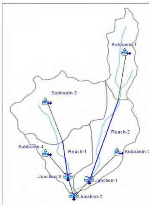
Figura 3.1.9.4-2 Maqueta de una cuenca con canales fluviales y puntos de confluencia según HEC-HMS
