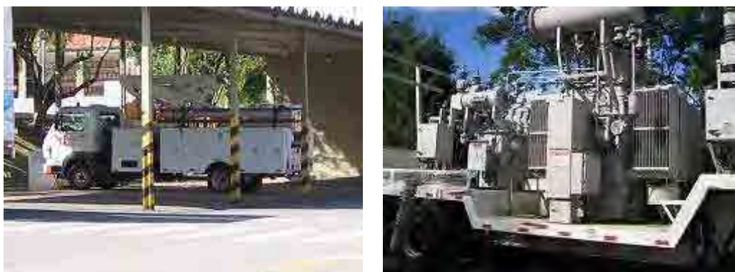
Figura 4.9-10 Veículos para o Trabalho de Manutenção (Veículo com Cesto Aéreo, Veículo com Transformador de Emergência)
