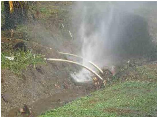
写真㉖：亀裂の入った給水管からの激しい漏水。配水圧が高すぎて漏水量が多い。
