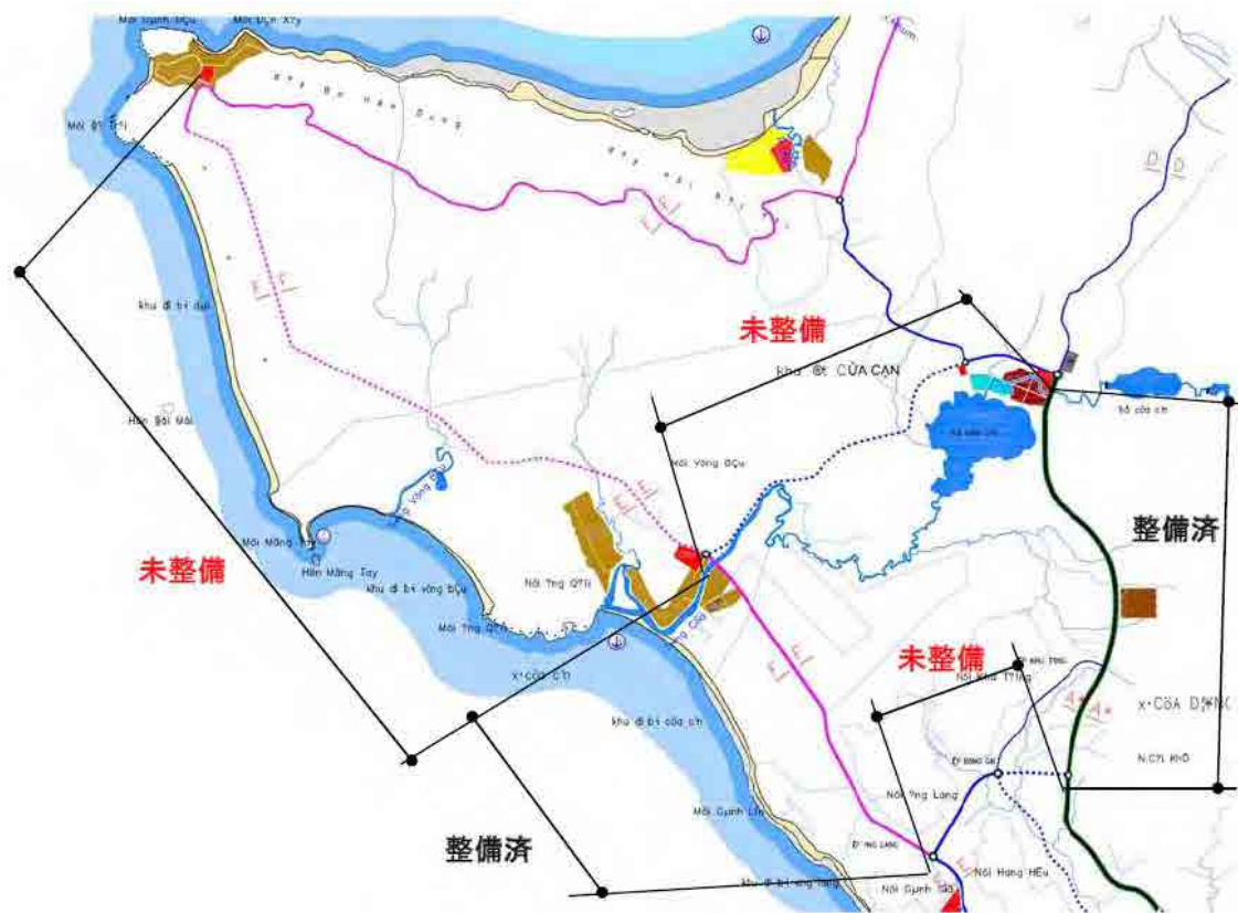
図 4-1-4-1 送配水ルートの道路整備状況
