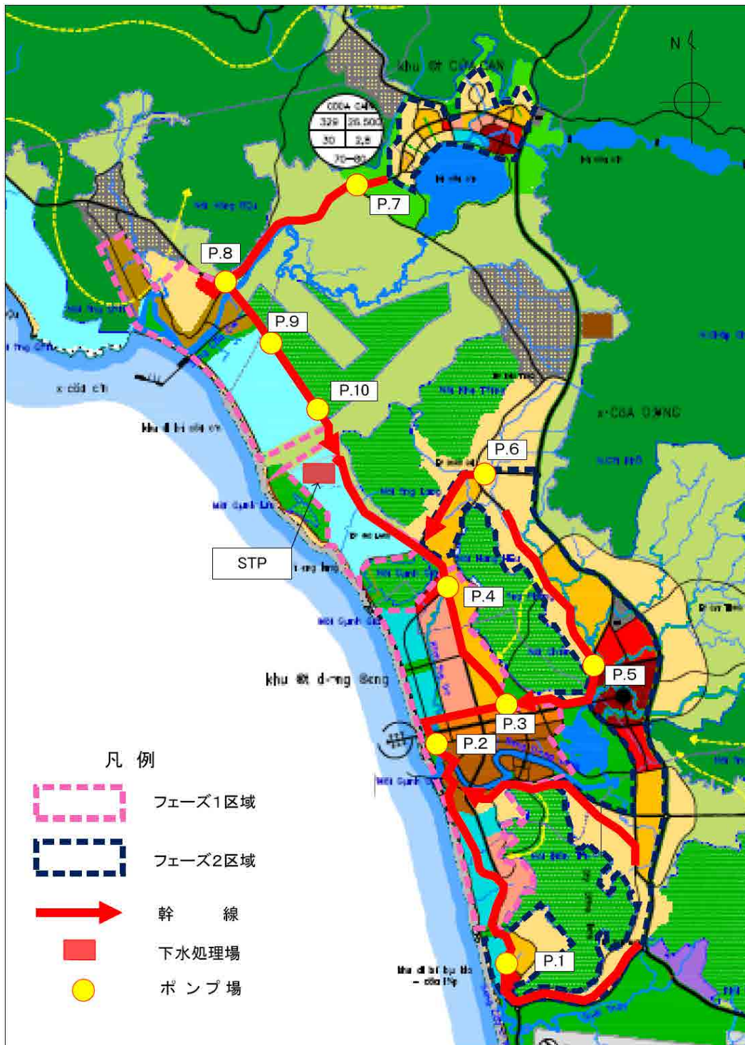
図 4-2-1-2 下水道主要施設のレイアウト図
