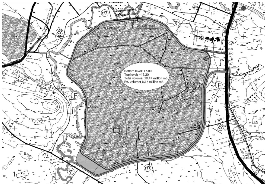
図-5 Cua Can 貯水池のレイアウトと浄水場の位置
