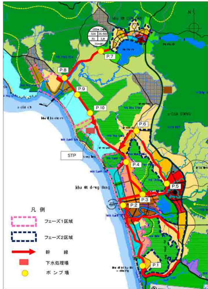
図-11 下水道主要施設のレイアウト図
