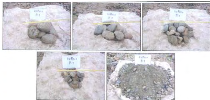
Materiales extraídos de la excavación de calicata
