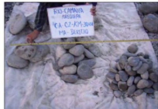
Materiales extraídos de la excavación de la calicata
