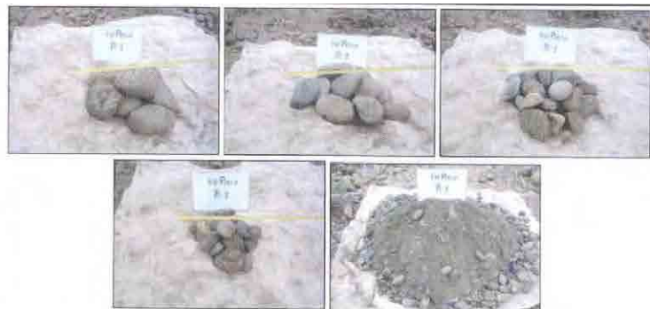
Materiales extraídos de la excavación de calicata
