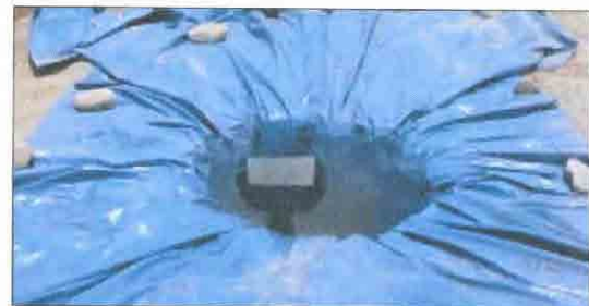
Llenado de agua a la calicata para determinar el volumen excavado
