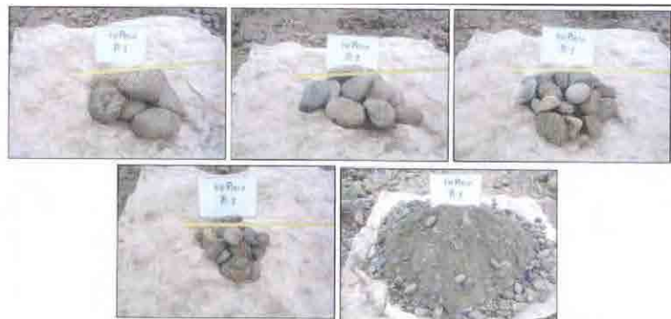
Materiales extraídos de la excavación de calicata
