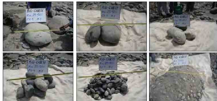
Materiales extraídos de la excavación de la calicata
