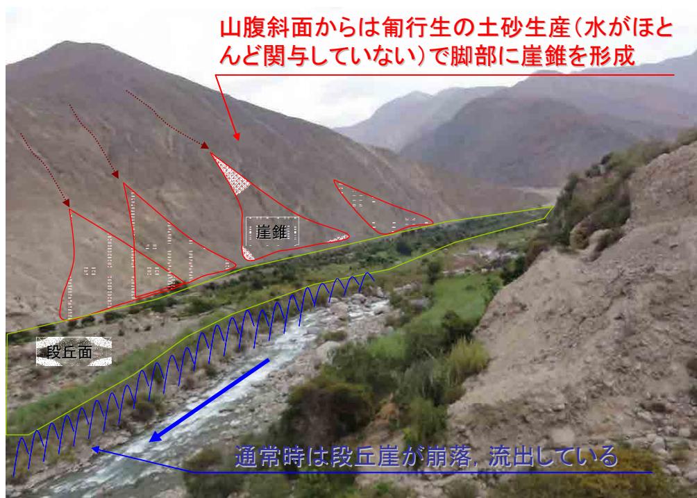
図-3.1.8-12 河道付近における土砂移動
