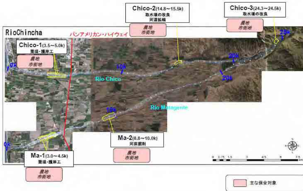
図-4.3.1-12 チンチャ川における重点洪水対策施設の位置
